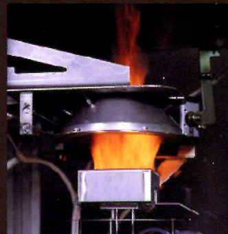
コーンカロリメーターによる 燃焼試験
