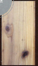
不燃木材に一般的な 2液型ウレタン塗料を塗装
